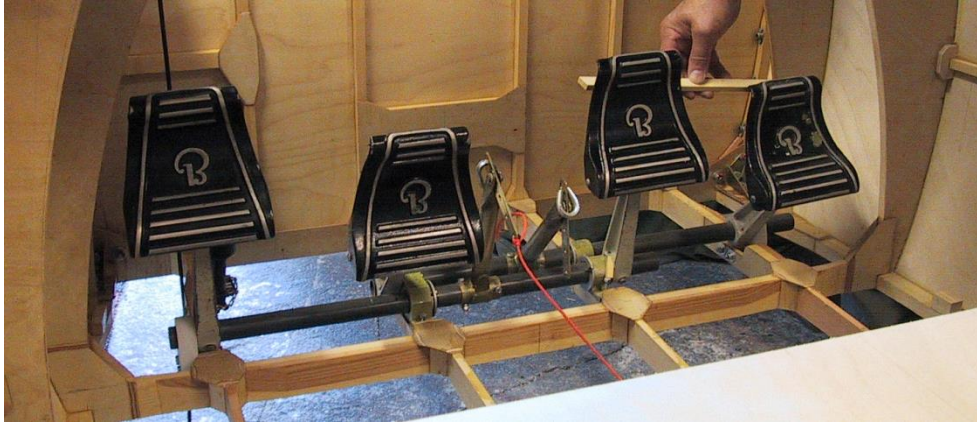
Vasemmalla puolen ohjaajalla on ”varvasjarrut” (rakennusaikainen kuva)
